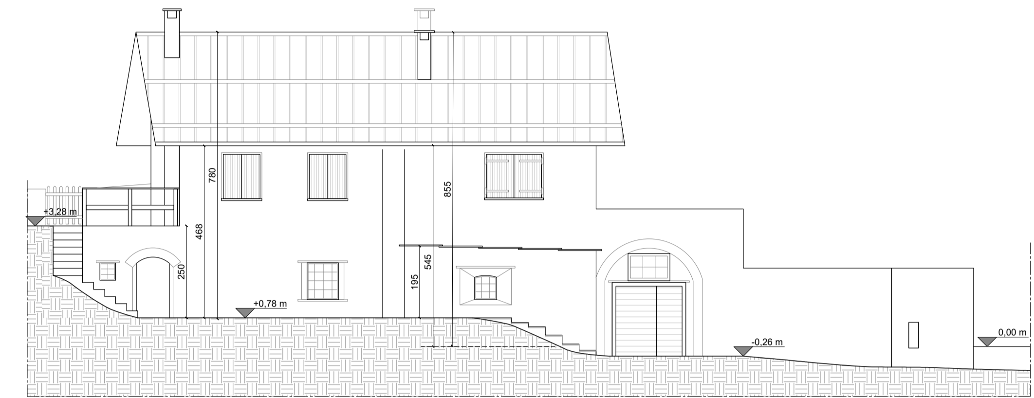
5 PROSPETTO SUD - STATO DI FATTO SCALE: 1:100
